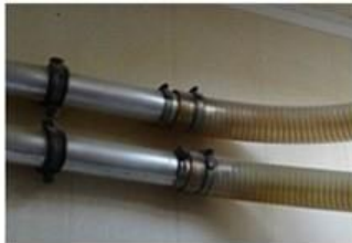
Flexibele koppeling met potentiaalvereffening
